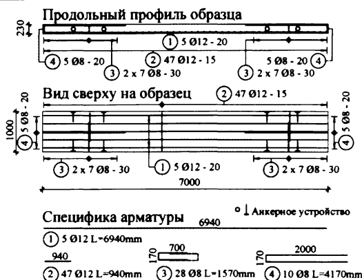
Рис. 1. Схема опалубки и армирования
